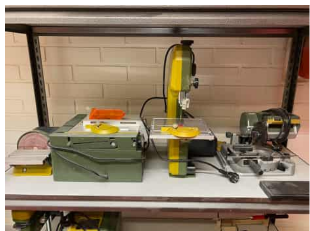
Laikkahiomakone, pöytäsaaha, vannesaha, katkaisu- ja jiirisaha (pöytämallit)
