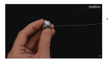
SLIDE THE THREAD AROUND THE PIG TAIL FEW TIMES
